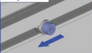
**Nota:** aflojar el tornillo + tuerca y hacerlo deslizar hacia el cofre delantero
